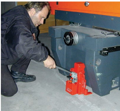
Ein EJ60-4S beim Anheben einer Erodiermaschine An EJ60-4S being used to lift a spark machine
